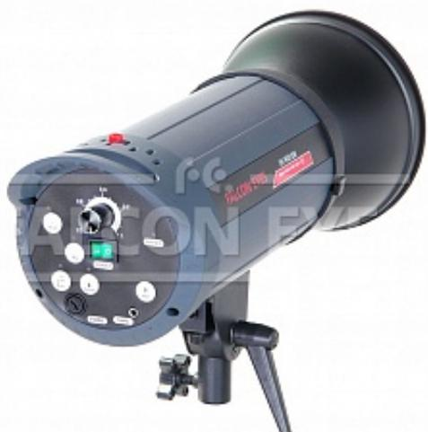
Профессиональная студийная вспышка мощностью 900 Дж, регулировка до 1/16 мощности, сброс избыточного импульса, пилотный свет 250 Вт, байонет Bowens.
