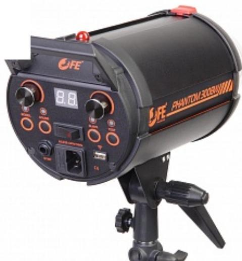
Импульсный моноблок с байонетом Bowens, мощность 300 Дж, регулировка мощности 5.0-8.0 (1/32-1/1) с шагом 0.1, перезарядка 0,2-0,7 с, длительность импульса 1/800-1/2000 с, моделирующая лампа 150 Вт, совместимость с пультом-синхронизатором SprintTrigger 16, алюминиевый корпус, в комплекте: пайрекс-колпак, защитный пластиковый колпак и синхрокабель.
